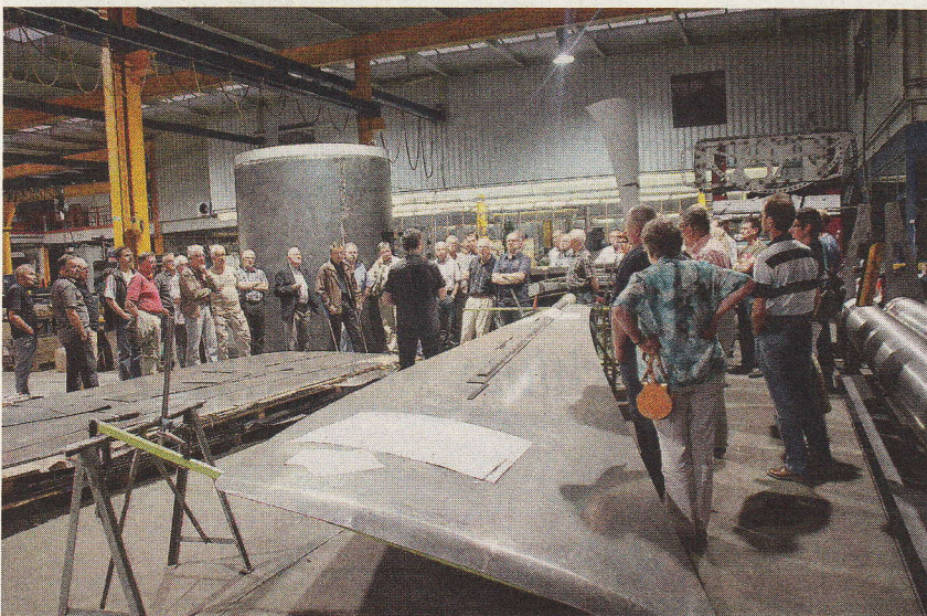
Eines der Turbinenblätter in der Endmontage, im Hintergrund der runde Sockel, auf welchen die Turbine zu stehen kommt. (Bilder: Roland Müller)
